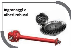
È stata adottata una coppia conica a spirale nei riduttori per operazioni ad alta coppia e ad alta velocità. Essendo la trasmissione a 90° aiuta anche a ridurre drasticamente il rumore. La scelta di un riduttore di grandi dimensioni e molto robusto è stata fatta per evitare surriscaldamenti e per ridurre al minimo le manutenzioni.
