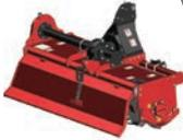
Il nuovo design dell'asta di regolazione a molla garantisce il livellamento del terreno e la facilità di regolazione del cofano.
