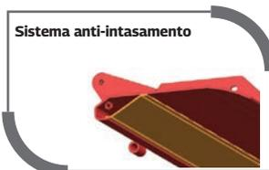
Una caratteristica interessante è il sistema anti-intasamento: una membrana in lamiera che impedisce al terriccio aderente/umido di intasare la macchina.
