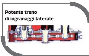
La fresa è inoltre dotata di un gruppo di trasmissione laterale a 3 ingranaggi, che assicura una trasmissione costante senza perdite di potenza. La trasmissione laterale è stata progettata in modo tale che i picchi di carico dovuti alle forze tangenziali che agiscono sul semi-asse vengano distribuiti uniformemente sulle piastre laterali.
