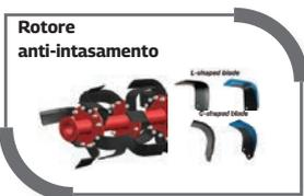
Il rotore a lame anti-intasamento può ospitare 2 tipi di lame, a C e a L, progettate per la rifinitura finale del terreno e la lavorazione dei residui colturali. Le lame sono disposte elicoidalmente attorno al rotore, in modo che esse entrino progressivamente nel terreno, riducendo così il consumo di energia. Questo sistema particolare contribuisce inoltre a ridurre il fenomeno dell'intasamento nella carena del rotore in caso di terreno bagnato.
